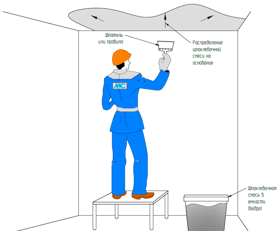
Рис. 18. Организация работ по нанесению шпаклевочной смеси
